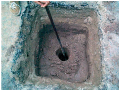
Figura 10.2 Exemplos de extração de corpos-de-prova e de poços de sondagem em pavimentos em uso
