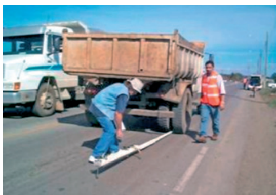
(b) Medida com viga Benkelman em campo
