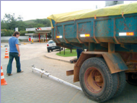
(b) Colocação da viga Benkelman e leitura inicial
