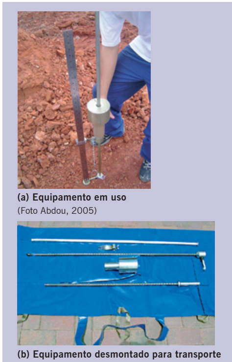
Figura 10.3 Exemplo de equipamentos DCP de avaliação estrutural expedita de subleitos e camadas de solo
