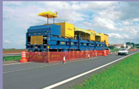
(f) Simulador brasileiro móvel tipo HVS em uso
