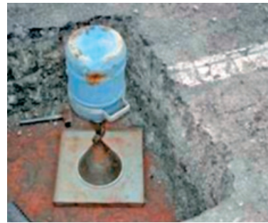
Figura 10.2 Exemplos de extração de corpos-de-prova e de poços de sondagem em pavimentos em uso
