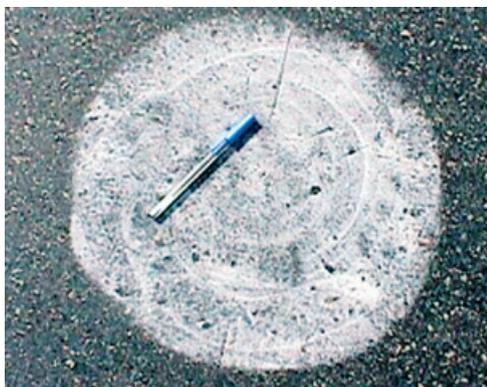
(a) Concreto asfáltico com macrotextura fechada
