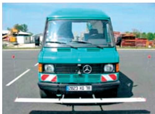
**Figura 9.11** Exemplo de equipamento munido de barra com ultra-som
