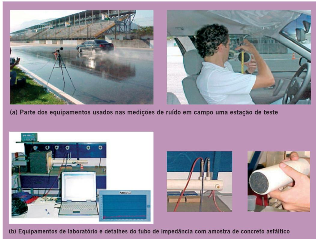
Figura 9.31 Exemplo de arranjos de conjunto de equipamentos para medições de ruído gerado com a contribuição do pavimento (Láo, 2004)
