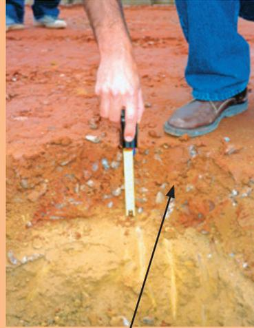
(a) Solo-brita descontinuo: detalhe da camada compactada
