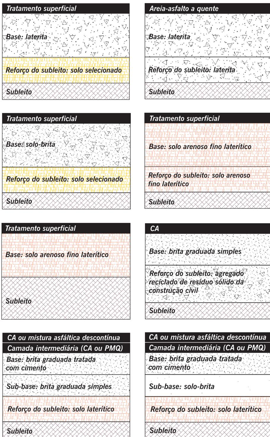
Figura 7.16 Estruturas típicas de pavimentos asfálticos
