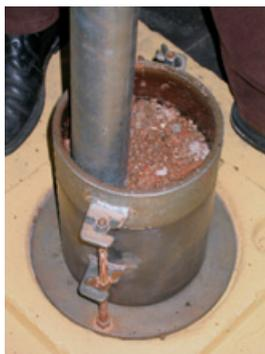
(a) Compactação de corpo-de-prova
