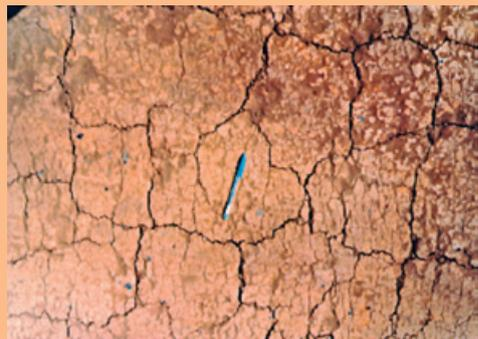
(d) Argila arenosa lateritica LG': trincas devido à perda de umidade da camada compactada
