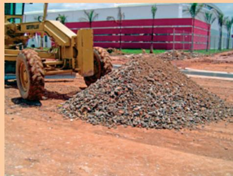
(d) Agregado reciclado de resíduo sólido da construção civil
