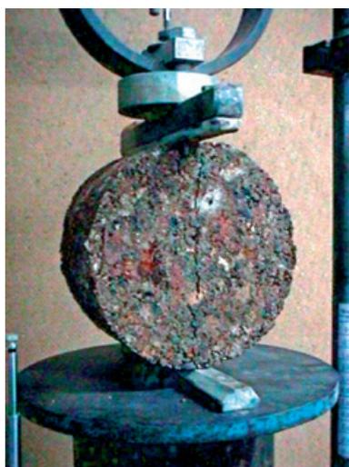
(a) Resistência à tração por compressão diametral
