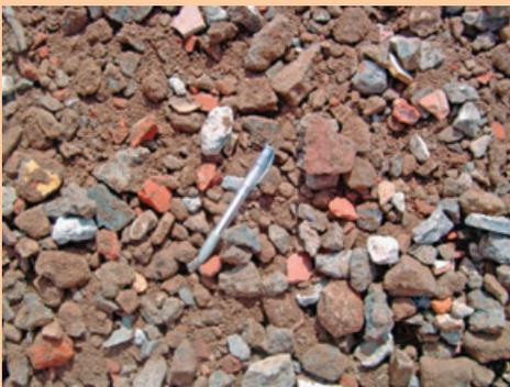
(e) Agregado reciclado de resíduo sólido da construção civil: detalhe da natureza e graduação
