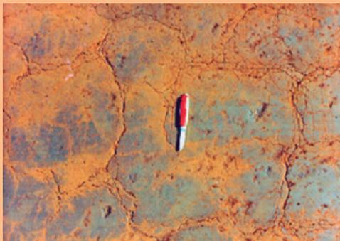
(c) Solo arenoso fino lateritico LA': trincas devido à perda de umidade da camada compactada
