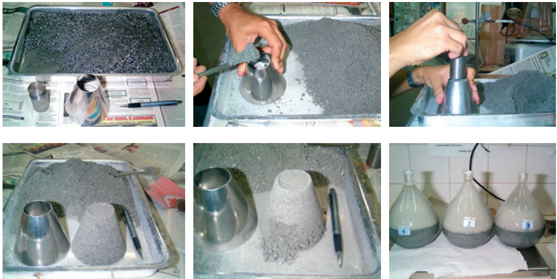
Figura 3.25 Esquema do ensaio de massa específica de agregados miúdos considerando a absorção pelo método ASTM C 127
