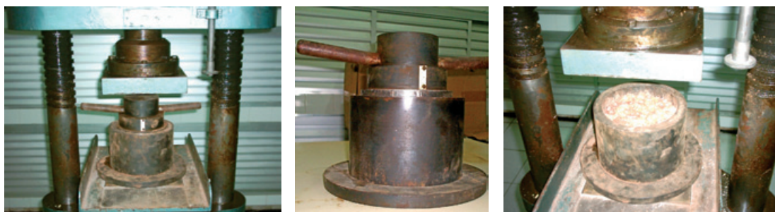
Figura 3.16 Conjunto de cilindro e êmbolo utilizado no ensaio de 10% de finos e prensa
